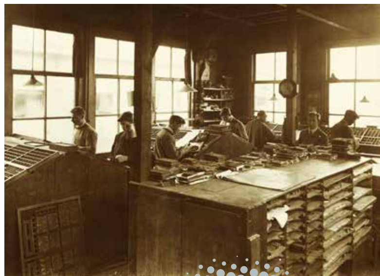
De zetterij anno 1920. Alles werd destijds met de hand in lood gezet!
